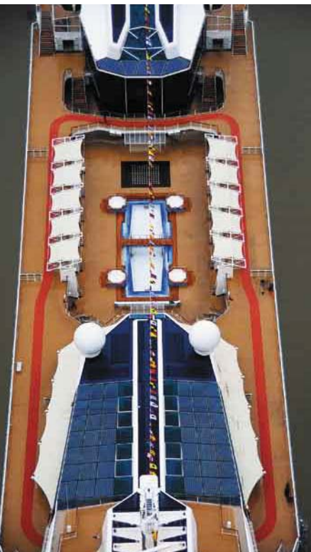
Vorn ist die Solariumanlage, oben im Bild sind die sieben Isolierglasmodule über dem Atrium zu sehen
